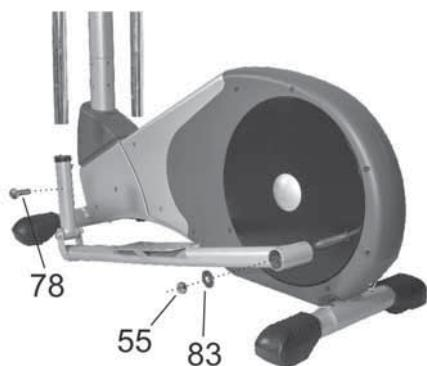
För in den främre vänstra änden av pedalrören i den nedre änden av handstödet och skruva fast med fyra skruvar. Upprepa proceduren för det högra pedalrören.
