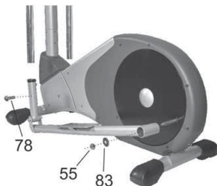
Pase el extremo frontal izquierdo del tubo del pedal por dentro del extremo inferior del manillar y sujételo con cuatro tornillos. Repita el proceso con el tubo del pedal derecho.
