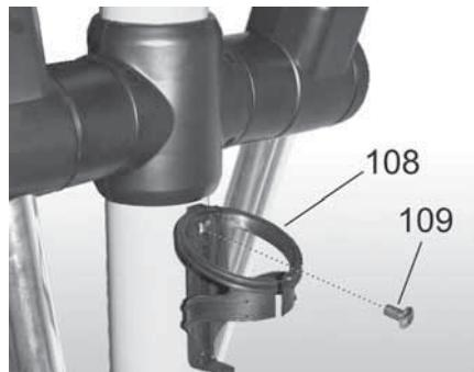
Montieren Sie den Flaschenhalter mit einer Schraube.
