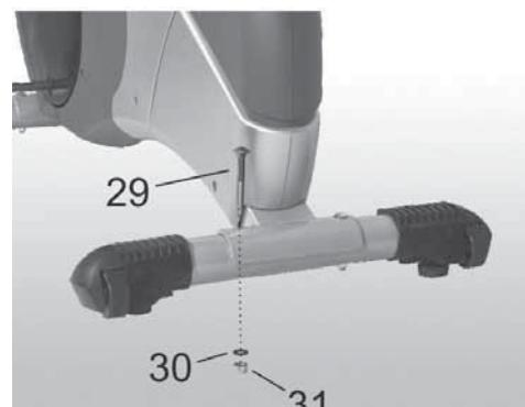
Fäst det främre stödet med transporthjulen vid ramen med två skruvar, brickor och muttrar.
