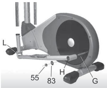
Infilare l'estremità anteriore sinistra del tubo del pedale all'interno dell'estremità inferiore del manubrio e fissare con quattro viti. Ripetere la procedura per il tubo del pedale destro.
