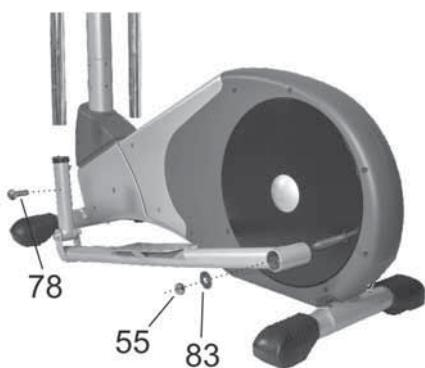
Leid de linkervoorkant van de pedaalbus in het ondereinde van het stuur en bevestig met vier schroeven. Doe hetzelfde voor de rechterpedaalbus.
