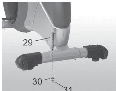
Fissa al telaio la base appoggio anteriore, provvista di rotelle, usando due viti, piattine di fissaggio e dadi.
