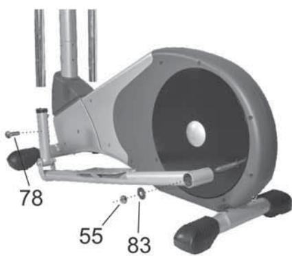
Führen Sie die linke Vorderseite des Pedalrohrs in das untere Ende der Griffstange ein und befestigen Sie diese mit vier Schrauben. Wiederholen Sie den Vorgang für das rechte Pedalrohr.
