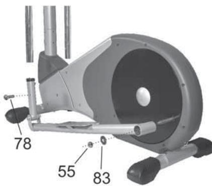
Pujota poljinvarren vasen etupää liikkuvan käsituen alapään sisään ja kiinnitä se neljällä ruuvilla. Toista toimenpide oikeanpuoleiselle poljinvarrelle.
