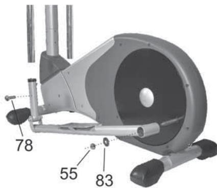
Passez la tête de la tige de pédale gauche dans la partie inférieure du guidon et serrez à l'aide de quatre vis. Répétez cette action pour la tige de pédale droite.
