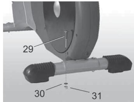
Das hintere Stützbein mit 2 Befestigungsschrauben, Unterlegscheiben und Arretierungsmuttern am Rahmen befestigen.
