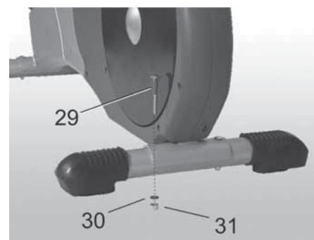
Fäst det bakre stödet vid ramen med två skruvar, brickor och muttrar.
