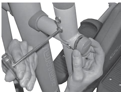
Plaats de handvaten en bevestig met in totaal vier schroeven. Duw de doppen over de as-schroeven.
