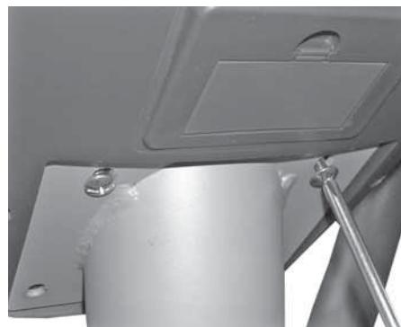
Verbind de kabels uit de voorste buis met de monitor. Duw de kabels in de voorste buis en installeer de monitor op het einde van de voorste buis. **BELANGRIJK!** Let erop dat u de kabels niet beschadigt! Bevestig de monitor met vier schroeven. Verwijder de bescherming van het monitorscherm en toetsenbord.
