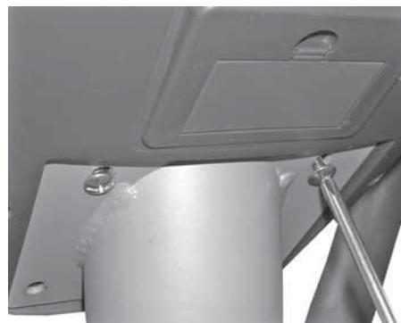
Schließen Sie die Kabel vom Frontrohr und dem Messgerät an. Drücken Sie die Kabel in das Frontrohr und installieren Sie das Messgerät am Ende des Frontrohrs. **BITTE BEACHTEN:** Die Kabel nicht zu beschädigen! Befestigen Sie das Messgerät mit vier Schrauben. Entfernen Sie die Schutzabdeckung von Bildschirm und Tastatur des Messgeräts.
