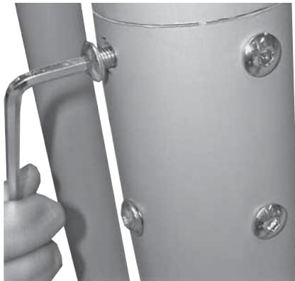
Styr bromsvajern och mätarvajern från ramen till framrören bakom stången vid den övre änden av ramstolpen. För ut bromsvajern ur framrören genom öppningen i motståndskontrollen. Mätarvajern kommer ut från överdelen av framrören. Skjut in framrören i ramstolpen: var försiktig så att du inte skadar mätarvajern! Skruva fast framrören ordentligt med sex fästsksruvar.
