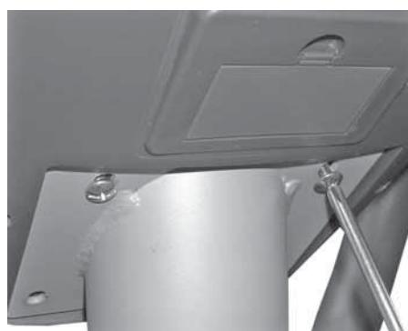
Anslut sladdarna som sticker ut ur framrören och mätaren. Skjut in sladdarna i framrören och montera mätaren på änden av framrören. **OBS!** Var försiktig så att du inte skadar sladdarna! Skruva fast mätaren med fyra skruvar. Ta bort skyddet från mätarskärmen och knappsatsen.
