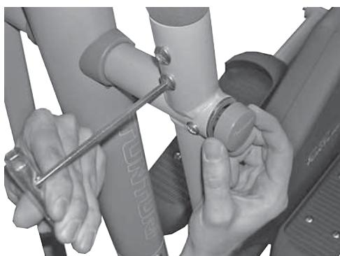
Installieren Sie die Griffe und ziehen Sie beide mit insgesamt vier Schrauben fest. Drücken Sie die Schutzstopfen auf die Achsenschrauben.
