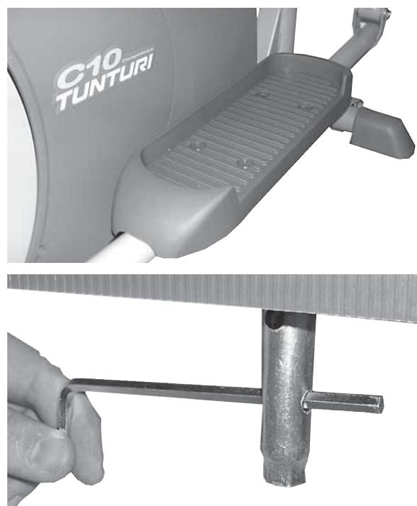
Befestigen Sie die Trittfächen mit vier Schrauben und einer Sechskantmutter an der gewünschten Stelle an den Pedalrohren. Befestigen Sie die Mutter mit dem in der Abbildung gezeigten Werkzeug.
